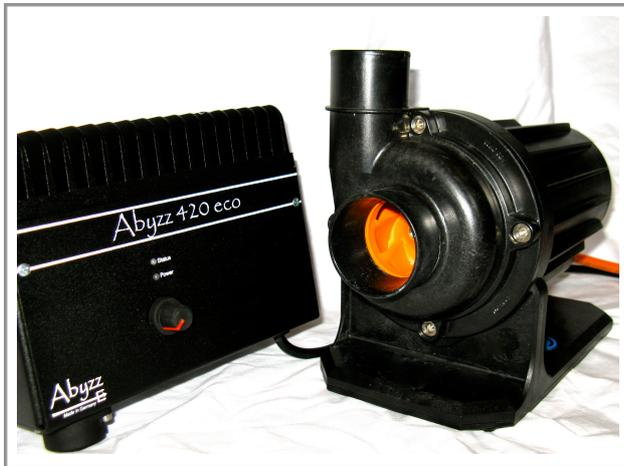
Die innovative *Abyzz 420 eco* Pumpe mit Titanläufer besteht aus einer leistungsfähigen Elektronik (Treiber) und einem sinuscommutierten dreiphasigen Synchronmotor (Pumpe). Der Wirkungsgrad des Motors beträgt über 90% und macht die Pumpe, in Verbindung mit der auf Ihren Leistungsbedarf einstellbaren Drehzahl, zu einer energiesparenden Lösung.
